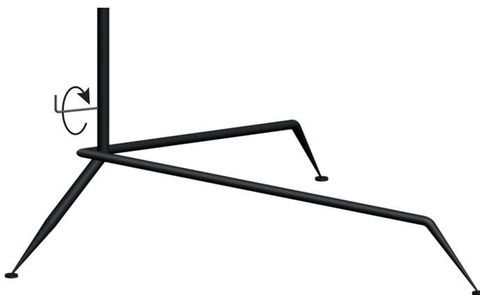
3. Déballer le bout des bras afin de pouvoir les emboîter sur le mât principal. Retirer les protections de câble en plastique rouge des tubes. Relâcher l'emballage des réflecteurs sans l'ôter complètement.
